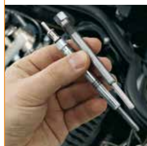
L'alésoir BERU (RA003 - 0 890 100 003) élimine les dépôts de calamine qui peuvent s'accumuler après le grippage entre la bougie de préchauffage et la culasse.
